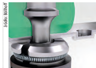
Jedną z zalet technologii klinczowania jest brak dodatkowych elementów złącznych (nitów, śrub), dzięki czemu jest to metoda szybka, tania i łatwa w realizacji.
